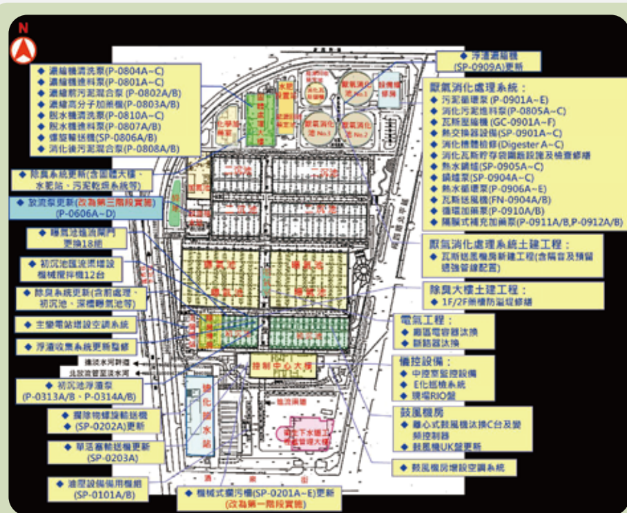
迪化污水處理廠委託操作維護 第六期暨設備更新 設備更新
